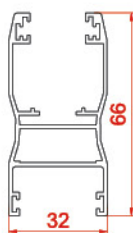
لنگه طرحدار جدید New vent with different designs 20658 0.8925 kg/m
