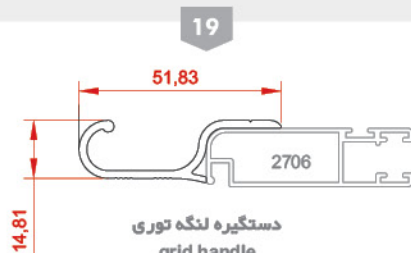
لنگه توری Grid Vent 21076 0.634 kg/m
