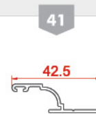
پایه توری لولایی فریم hinged base vent Grid 10291 0.2310 kg/m
