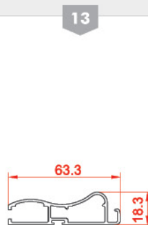
لنگه توری Grid vent 21533 0.29 kg/m
